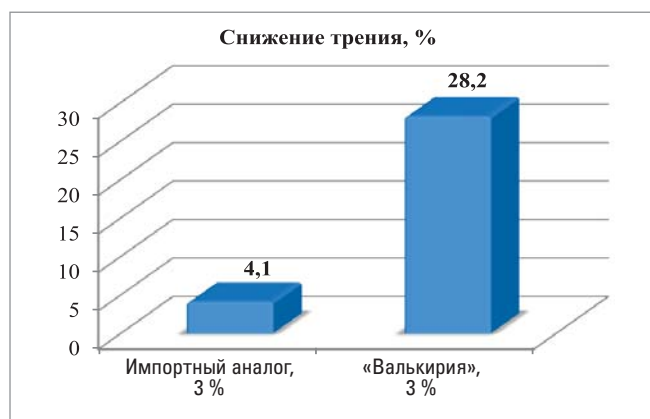
Рис. 11. Снижение коэффициента трения БР в присутствии реагента «Валькирия»
