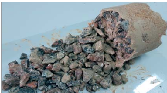
Рис. 7. Корка кольматирующего материала BIT-Plug марки M после тестирования на стенде производства ООО НПП «БУРИНТЕХ»
