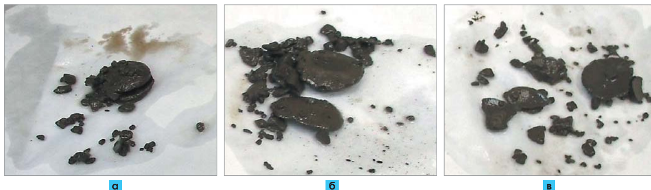
Рис. 12. Влияние использования реагента «Валькирия» на целостность шлама:
