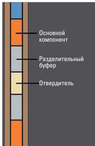
Рис. 9. Схема поочередной закачки компонентов BIT-SBC
