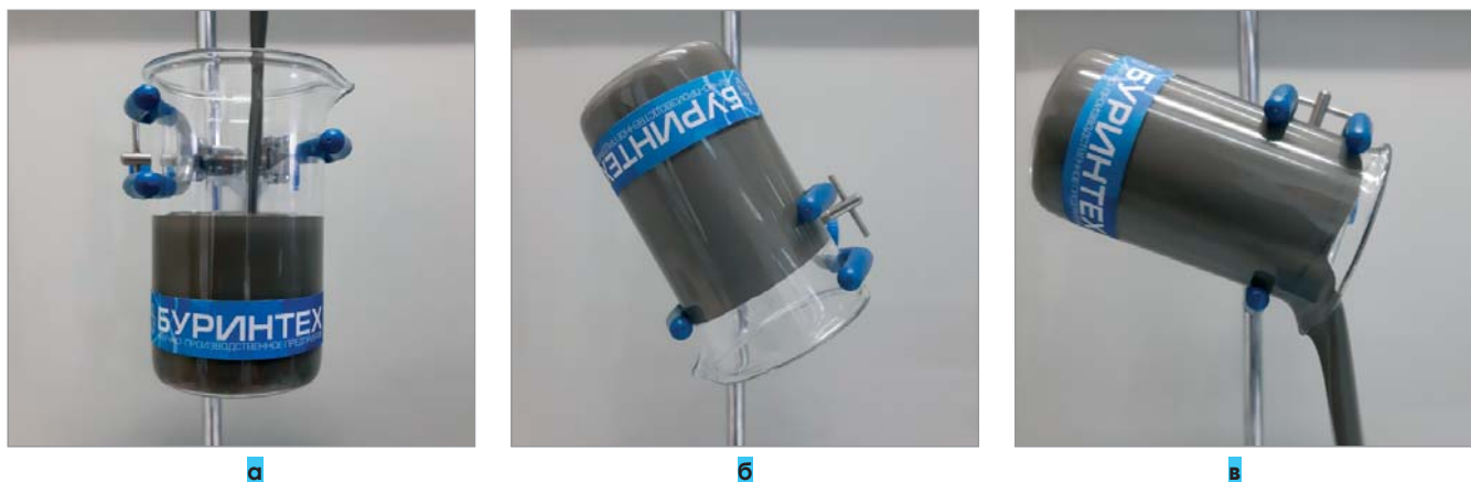
Рис. 3. Раствор материала BIT-Cem-Fix до и после механического воздействия:
