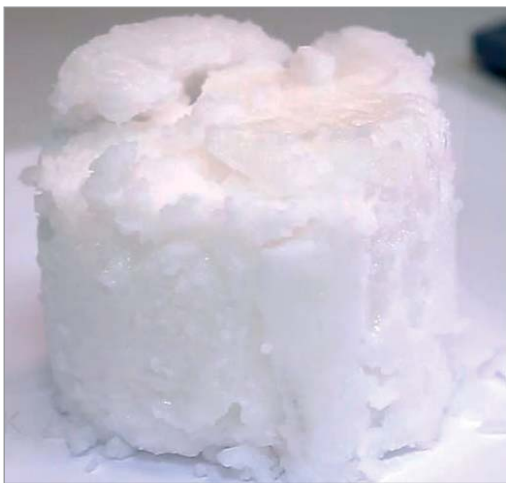
Рис. 8. BIT-SBC через 60 секунд после смешения компонентов
