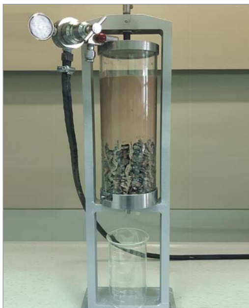
Рис. 6. Стенд для тестирования и демонстрации кольматирующей способности
