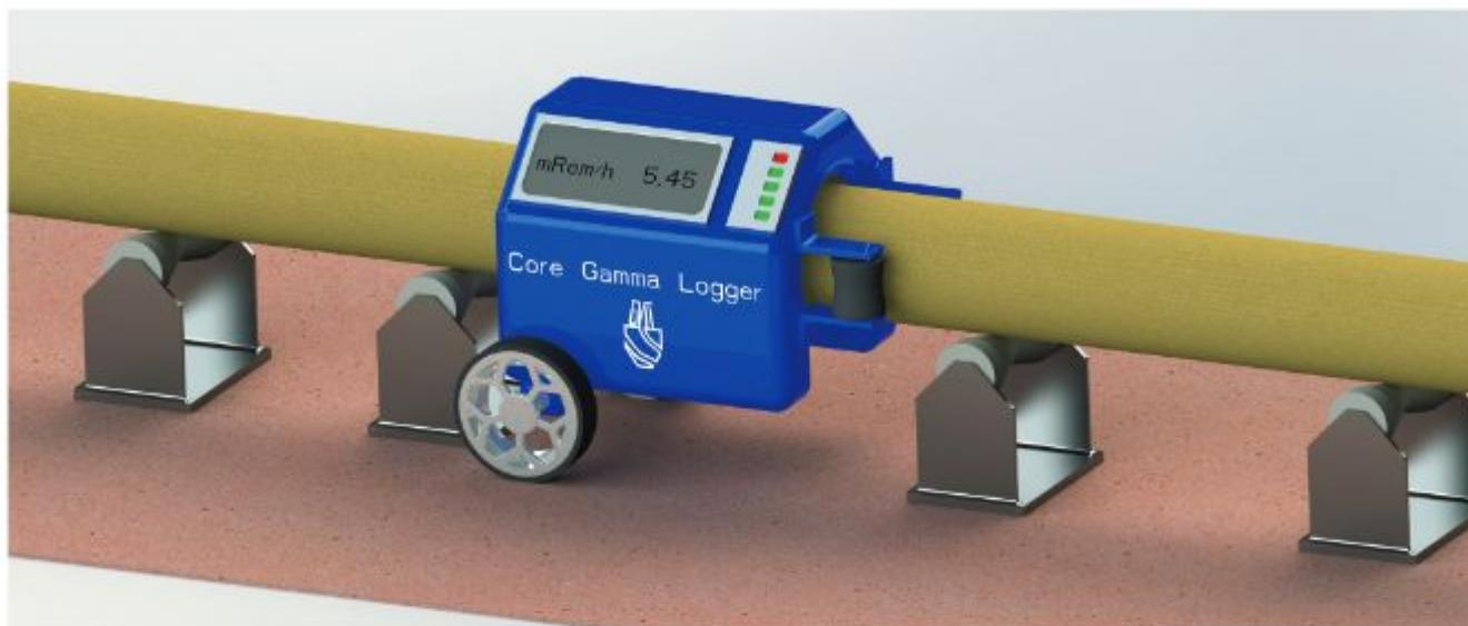
Предназначено для сканирования отобранного керна по длине в условиях буровой и определения общей гамма-активности для привязки керна к гамма-каротажу скважины.
