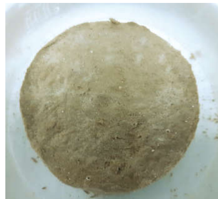
Рис.3. Кольматирующий материал «BIT-Plug» марки F в воде, через 24 часа
