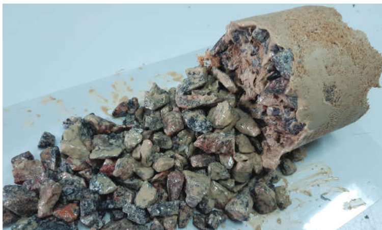
Рис.5. Корка кольматирующего материала «BIT-Plug» марки М, после тестирования на стенде производства ООО НПП «БУРИНТЕХ»
