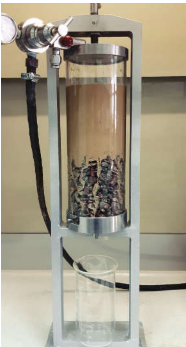
Рис.4. Стенд для тестирования и демонстрации кольматирующей способности
