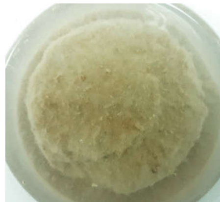
Рис.2. Кольматирующий материал стороннего производителя в воде, через 24 часа
