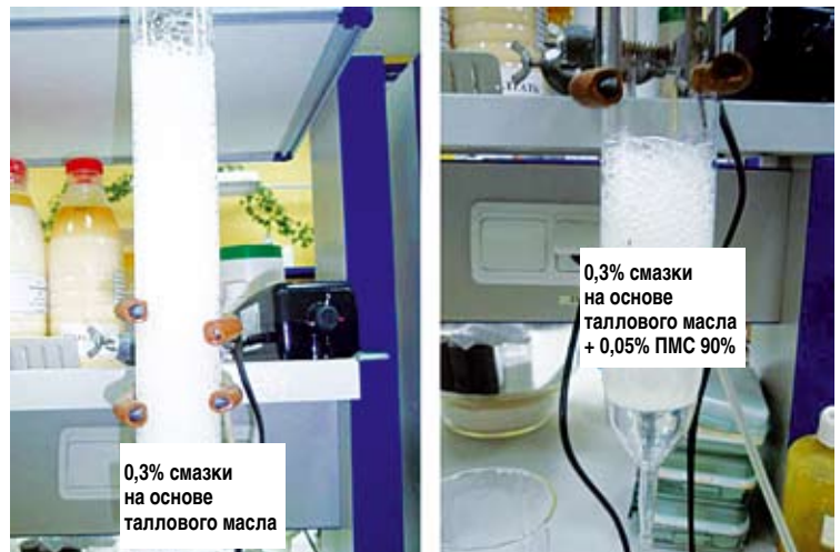
Рис. 2. Применение барботажного метода
