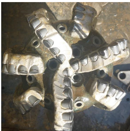
Рис. 5. Состояние PDC долота после подъема
