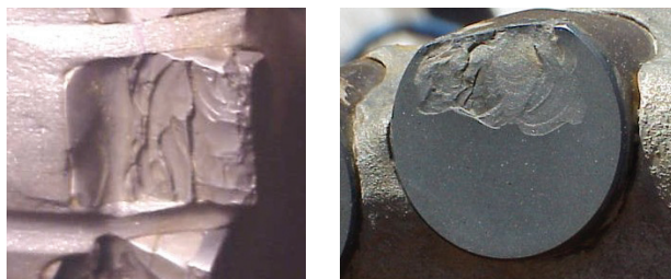
Рис. 1. Ударный износ PDC резцов
