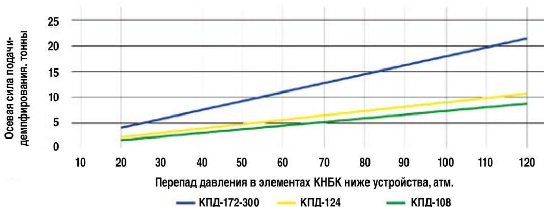
Рис. 3. Характеристики работы корректоров подачи-демпферов производства ООО НПП «БУРИНТЕХ»
