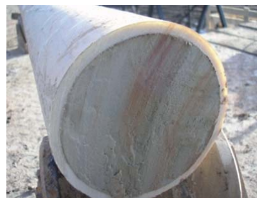
Рис. 5. Фото среза тубуса с керном
