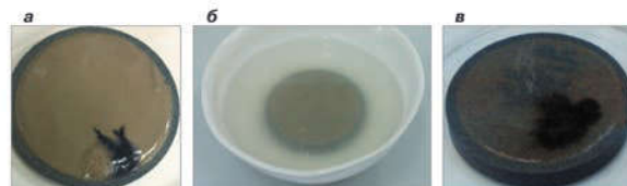
Рис. 3. Воздействие брейкера на фильтрационную корку: а – исходная корка; б – корка в растворе разрушителя; в – корка после химической обработки в течение 16 ч при температуре 65 °С
