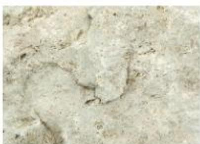
Более восприимчивы к изменению нагрузки на долото, чем к частоте вращения. Важно следить за вертикальной вибрацией долота. Кремнистые включения, часто встречающиеся в известняках и доломитах, могут двигаться и вращаться под вооружением долота по поверхности забоя – похожее случается при бурении трещиноватых пород. Это может перегрузить элементы режущей структуры долота, приводя к скальванию и слому вооружения. Не использовать максимальные значения нагрузки и частоты вращения.
